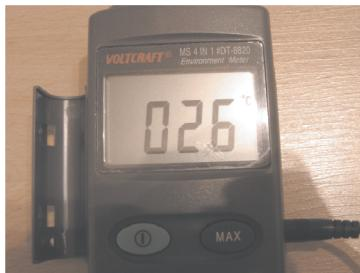
5. K měření vlhkosti vzduchu použijte čidlo vlhkosti. Odečtěte údaje na displeji.
