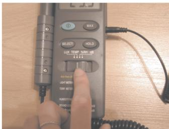
3. K měření intenzity světla použijte světelný senzor, ze kterého před měřením sejměte ochranný kryt. Po odečtení údajů na displeji kryt opět nasad'te.
