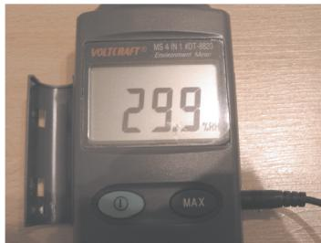
6. K měření hladiny zvuku použijte mikrofon. Odečtěte údaje na displeji.
