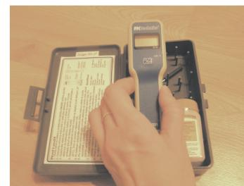
2. Přístroj zapněte zmáčknutím tlačítka ON/OFF. Sudejte čtyřhranný ochranný kryt. Z měřícího senzoru (=elektrody) sundejte ochrannou kulatou čepičku
