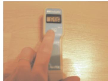
4. Vypněte přístroj tlačítkem ON/OFF. Elektrodu omyjte proudem vody a vysušte hadříkem nebo papirovým kapesníkem.
